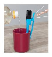
\*みずいろクリップ クリップ先端のセンサーで水位をア ラームでお知らせ、アラームが鳴ると 自動的にタイマーが作動します(最長 6分)、クリップ上部のカラーセンサ ーで 22 色の判別が可能
